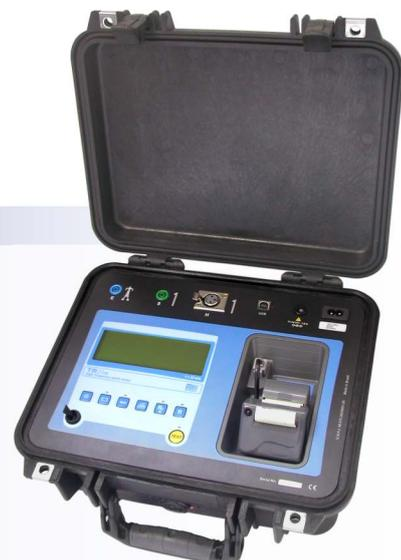
A verificação da qualidade do aterramento das torres de linhas de transmissão de energia apresenta uma séria dificuldade em razão de todas elas estarem eletricamente interconectadas através dos cabos de guarda (para-raios) utilizados para proteger as linhas das descargas atmosféricas.
